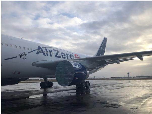
Un vol parabolique est un vol au cours duquel plusieurs paraboles sont effectuées. En réalité, l'avion effectue une **trajectoire semblable à une parabole**, ce qui permet aux personnes et matériel se trouvant à bord de l'avion d'avoir la **sensation d'impesanteur**. A bord de l'A310 Zero-G de Novespace, nous allons effectuer environ 30 paraboles afin de tester notre système I CARE. Nos expérimentateurs et notre expérience pourront profiter de 22 secondes de microgravité par parabole !
