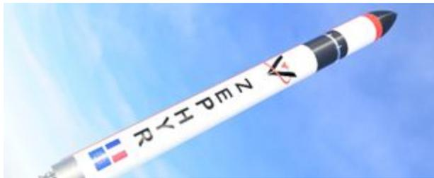
Zephyr est un lanceur léger (35 kg de capacité en orbite basse polaire) dimensionné pour être facile et rapide à produire grâce aux innovations de l'entreprise en terme d'impression 3D. **Dédié au marché des CubeSats**, il permettra aux opérateurs de nanosatellites d'avoir le choix sur l'orbite visée
